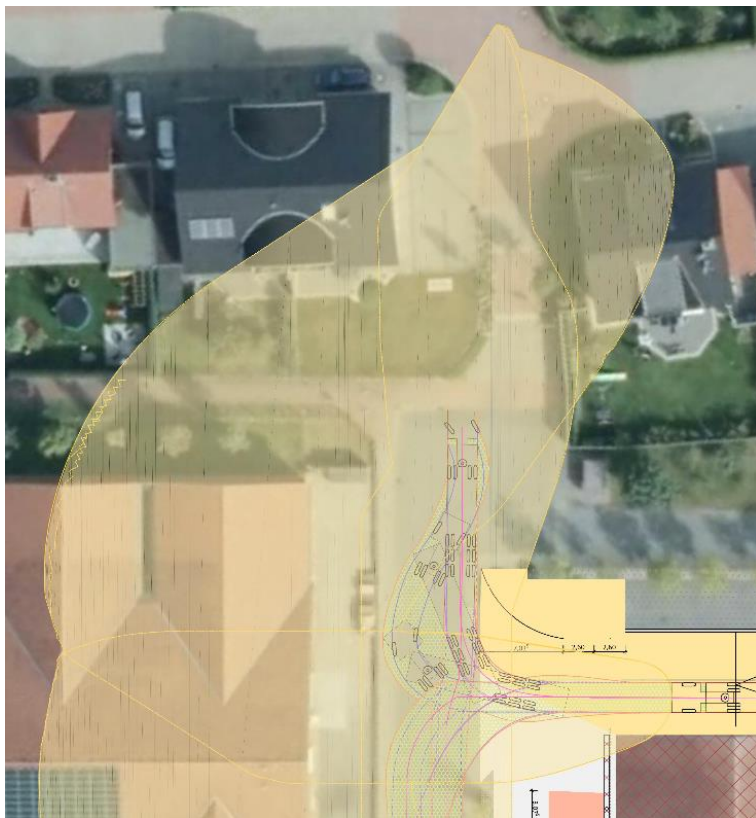
Abbildung 14 Lichtkegel Abblendlicht Lkw 17 (verkleinert, o. M., ohne Nordpfeil)
